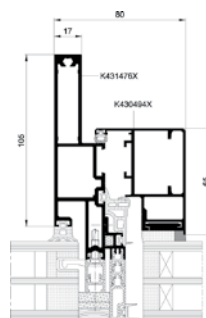
przekrój przez słup z oknem MB-SR50N IW – wersja EFEKT
