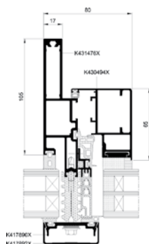
przekrój przez słup z oknem MB-SR50N IW – wersja standard
